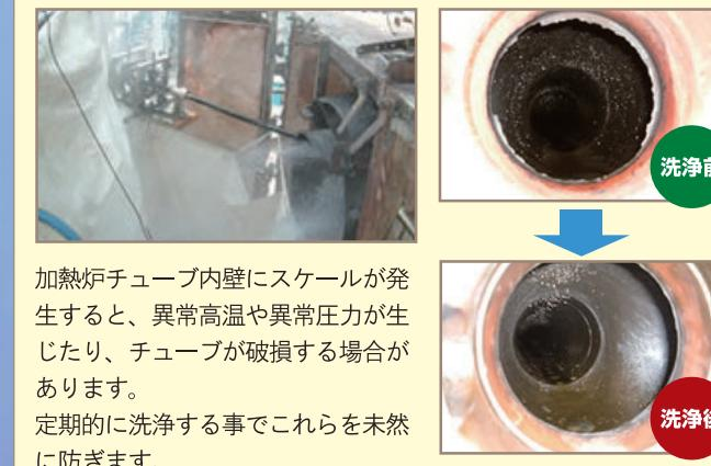
加熱炉チューブ内壁にスケールが発生すると、異常高温や異常圧力が生じたり、チューブが破損する場合があります。定期的に洗浄する事でこれらを未然に防ぎます。
